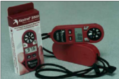
Figura 6. El Kestrel 3000 es una herramienta económica que mide las condiciones ambientales, lo cual es esencial al realizar inspecciones infrarrojas en exteriores.
