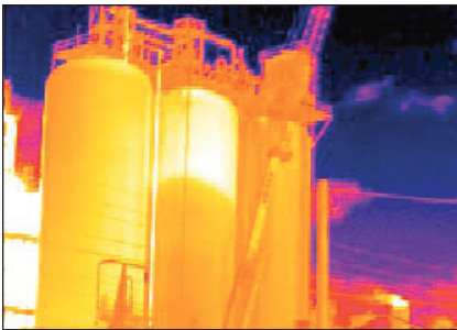
Los niveles pueden verse en los dos tanques (izquierda y centro) influenciados por el Sol. Mientras que el tanque de la derecha aparenta estar lleno.
